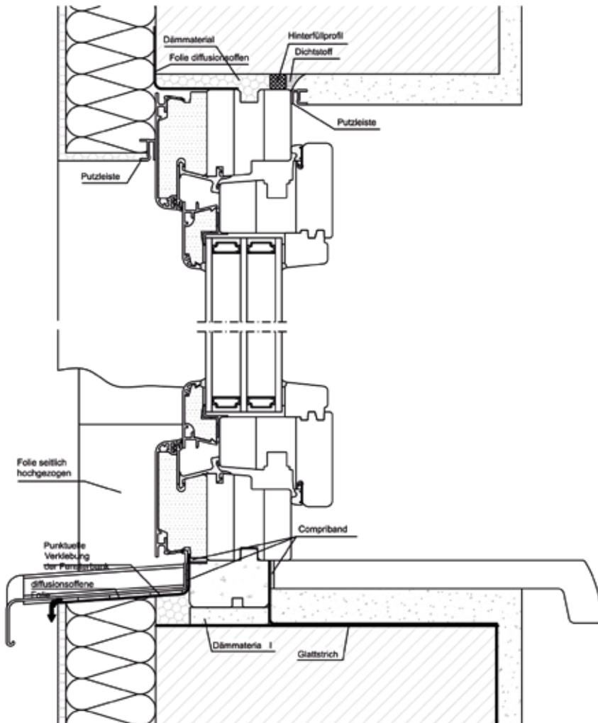
Bauanschluss mit Alu-Bodenschwelle 30mm.
