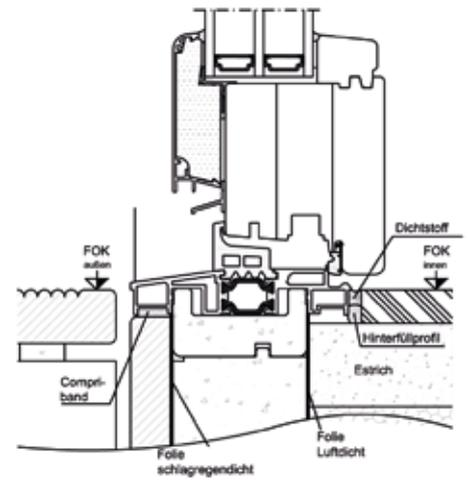
Bauanschluss mit Purenitprofil unten
