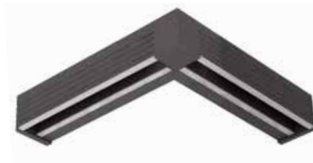
Winkelkombination bauseits fertig montiert Höhe Füllblock = Außenhöhe Raffstorekasten - 15 mm Zum bauseitigen Verputzen
