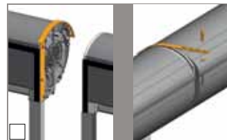
Befestigungsbügel für Kombination von Elementen.
